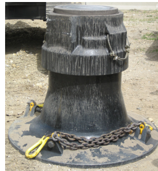
Bild 1. Impulsverdichter: (a) Foto, (b) Systemaufbau (aus [9]), (c) Verdichtungsfuß mit Schlaghaube (aus [1]) Fig. 1. Impact compactor: (a) Photo, (b) Configuration (from [9]), (c) Impact foot with driving cap (from [1])
