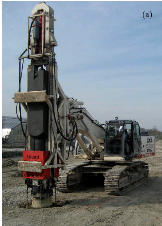
Bild 1. Impulsverdichter: (a) Foto, (b) Systemaufbau (aus [9]), (c) Verdichtungsfuß mit Schlaghaube (aus [1]) Fig. 1. Impact compactor: (a) Photo, (b) Configuration (from [9]), (c) Impact foot with driving cap (from [1])
