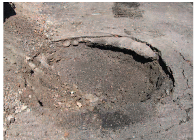
Bild 17. Verdichtungskrater nach dem ersten Übergang (aus [1]) Fig. 17. Compaction crater after the first pass (from [1])
